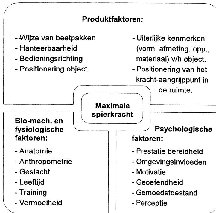
Figuur 9.10 Factoren die van invloed zijn op het uitoefenen van krachten (naar Fährlich et al., 1983).
